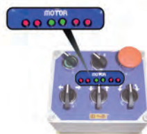
Электроиндикатор скорости вращения моторов (оборотов в минуту)
